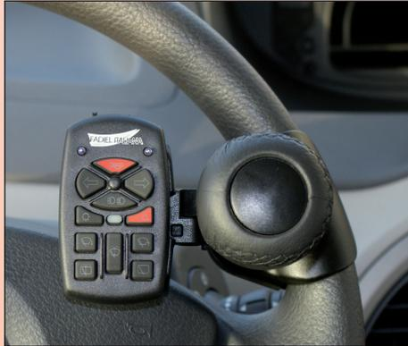
▲ Boule fixée au volant à droite ou à gauche avec commandes principales
