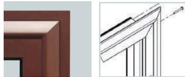
1 équerre plate + 2 vis pour un alignement parfait de la coupe d'onglet et pour plus de rigidité. (Permet de livrer le précadre démonté pour les grandes dimensions)
