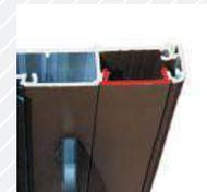
▶ Fixations invisibles à l'intérieur du tableau (cachées par un closoir clipsable après vissage) pour une finition et une esthétique produit parfaites (précadre avec pré-perçage de Ø 6 mm).
